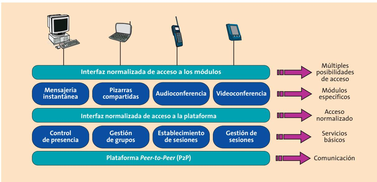
Figura 3. Estructura de la plataforma P4P
